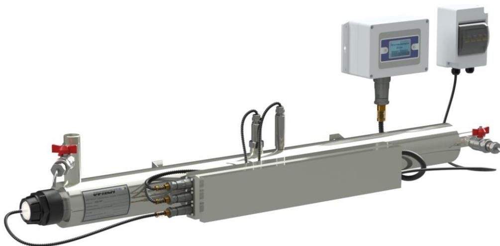
Установка предназначена для ультрафиолетового обеззараживания **сточной** воды. Условия эксплуатации: в закрытых, отапливаемых, вентилируемых помещениях при температуре окружающего воздуха от +5°C до +35°C и относительной влажности воздуха с верхним значением 80% при +25°C. Температура исходной воды от +1°C до +30°C.
