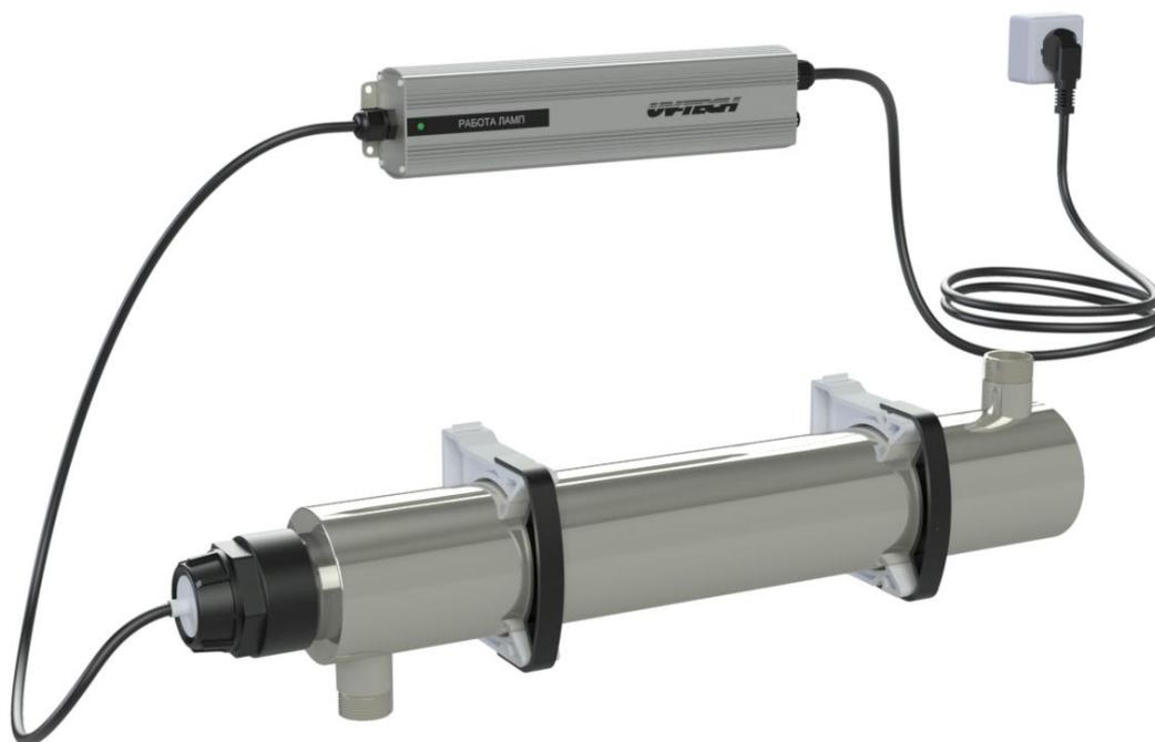
Установка предназначена для ультрафиолетового обеззараживания **сточной** воды. Условия эксплуатации: в закрытых, отапливаемых, вентилируемых помещениях при температуре окружающего воздуха от +5°C до +35°C и относительной влажности воздуха с верхним значением 80% при +25°C. Температура исходной воды от +1°C до +30°C.
